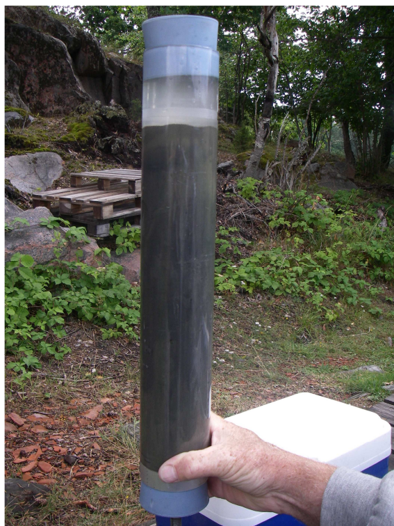
Figur 1. Sedimentpropp i ett plaströr. De två översta centimetrarna av sedimentet läggs i en burk och skickas på analys.
