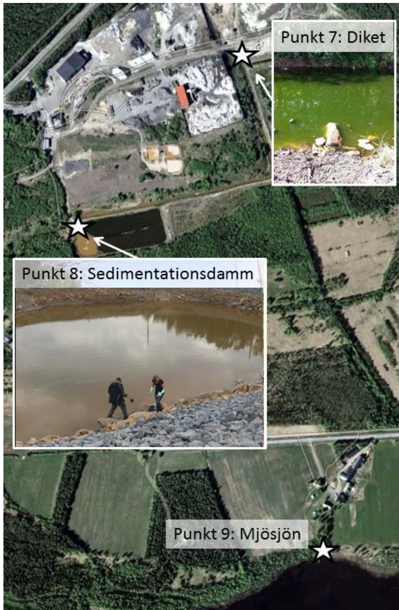
Figur 3. Vid Brännkläppens avfallsanläggning togs tre prover, varav två på deponiområdet och en i Mjösjön som är recipient för lakvatten från deponin.
