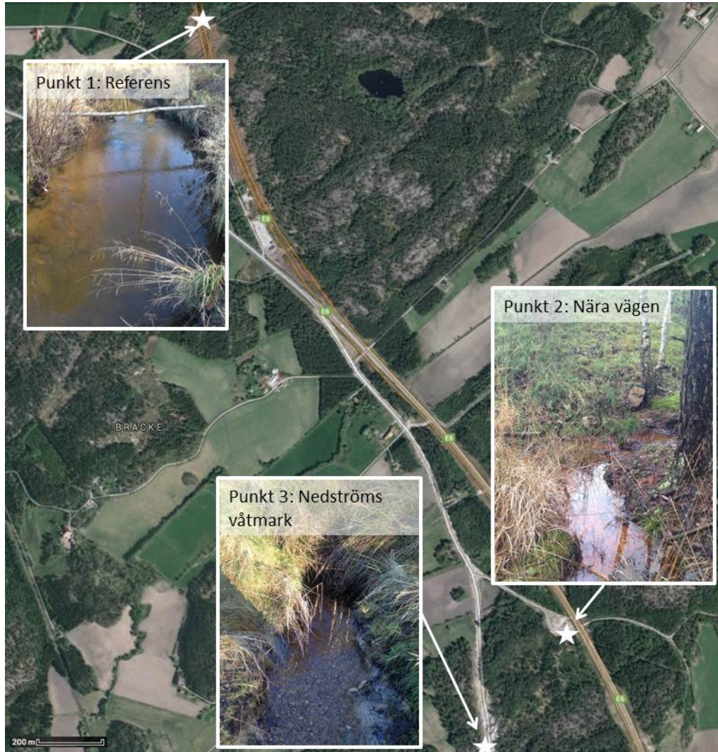
Figur 1. För att undersöka läckage och spridning av betongtillsatser från väggkroppen togs prov på tre punkter. Punkt 1 är en uppströms belägen referens som inte påverkas av den återvunna betongen. Punkt 2 är vald för att vara så nära den återvunna betongen som möjligt. Punkt 3 är belägen ca 300 m från väggkroppen med betong.
